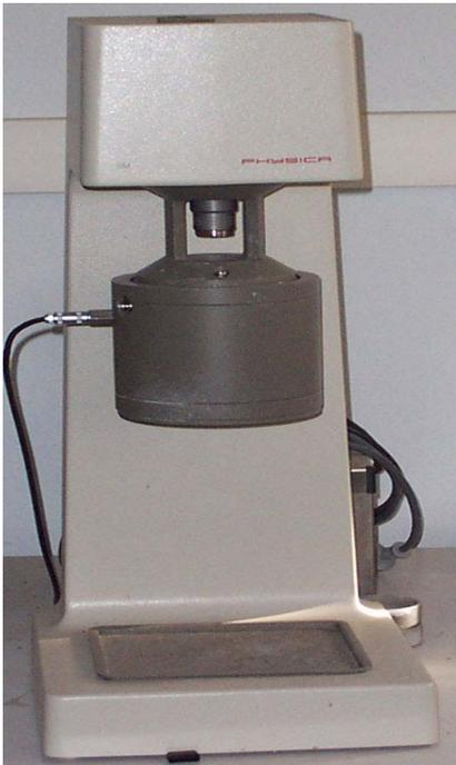
Figure 11 : rhéomètre PHYSICA MC100.
