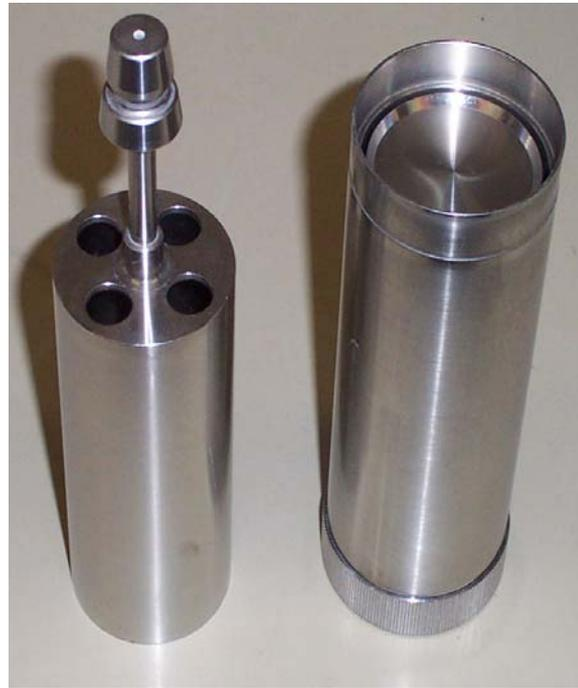
Figure 12 : cellule de mesure Z1 DIN à double entrefer.
