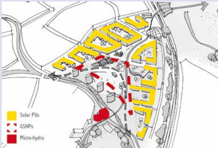
Situation des dispositifs de production d'énergies renouvelables. En jaune : des panneaux solaires ; en pointillés : le réseau des pompes à chaleur (GSHPs - Ground Source Heat Pump Systems) ; en rouge : la mini-centrale hydroélectrique. Crédit : © Baca Architects.
