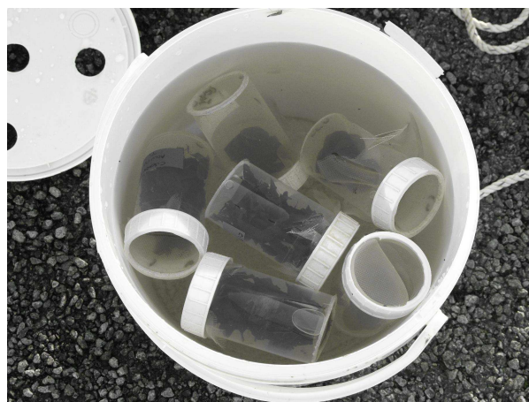
Figure 12 : illustration de 6 systèmes d'encagement (chacun contenant 20 gammares et des feuilles d'aulne)
