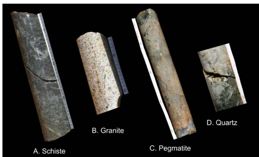
FIGURE 1.2 – Exemples de roches cristallines. Carottes prélevées sur le forage FC4, Saint-Brice en Coglès.
