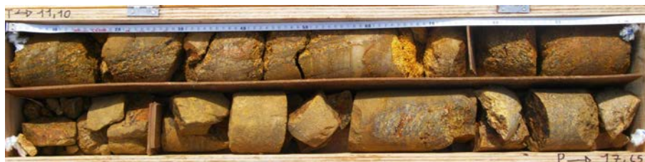
FIGURE 3.9 – Carottes du forage FC4 entre 11.10 m et 17.45 m. Schistes briovériens tachetés, altérés et oxydés avec alternances de filons granitiques arénisé (hiatus). Plan de fracturation sub-horizontale.
